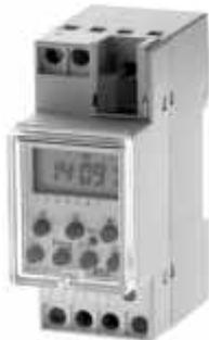
Die 2-Kanal-Wochenschaltuhr ist ein Reiheneinbaugerät mit integriertem Busankoppler zum Einbau in Verteilungen. Die Verbindung zum EIB wird über eine Busanschlußklemme hergestellt.
